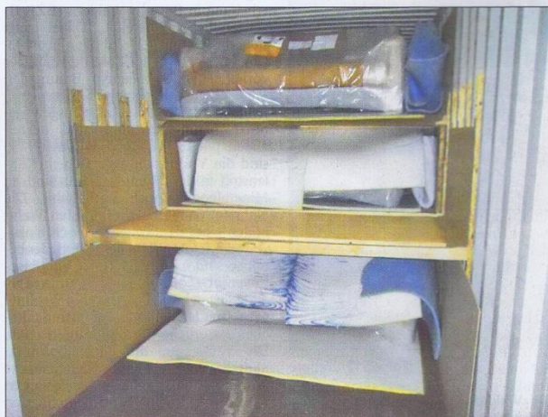
Die Elemente zur Ladungssicherung lassen sich werkzeuglos und auch geräuscharm montieren und auch demontieren
